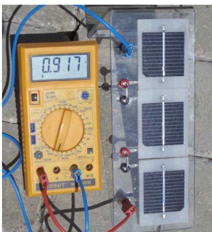
SUSE 4.33 mit Messung des Kurzschlussstroms 0,917 A Ein Schüler mit SUSE 4.2, 4.33, CM3 SEKII- Experiment mit SUSE 5.0, 5.16, 5.22 + PC-Messung
